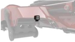
LED-Scheinwerfer Standard am Versatzkasten des Knickarmes montiert
