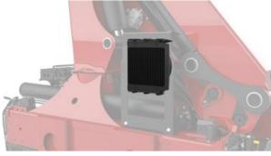
**ÖLK01 - Ölkühler 8,5kW, montiert**
