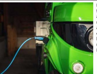
Der Ladeprozess gestaltet sich einfach und folgt damit der Logik eines unkomplizierten, alltagstauglichen Transporters. Über jede normale Haushaltssteckdose kann das aCar aufgeladen werden. Darüber hinaus garantiert das optionale Starkstromladen über die konventionelle Starkstromdose mit externem Ladegerät einfachsten Einstieg in die Elektromobilität.
